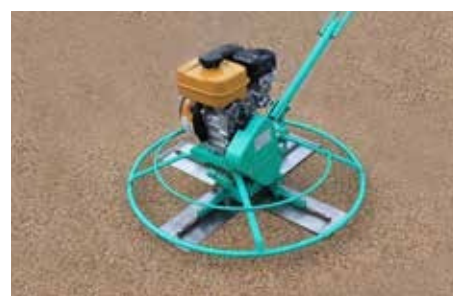
6. Compactar el material con llana mecánica
