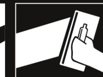
Frotar con llana acrílica después de la segunda capa.
